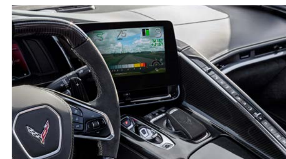
Performance Data Recorder zur Analyse von Rennstreckenrunden.
